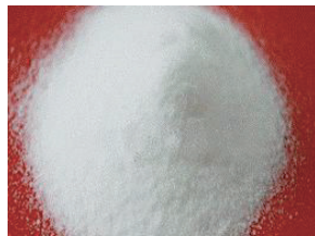
그림 6. LCD 폐유리의 미분말
