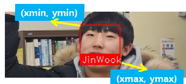
그림 8. 얼굴 인식 모듈 실행 결과 예시 Fig. 8. Example of face recognition module execution result
