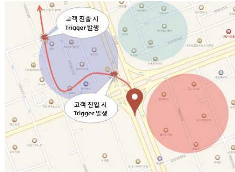
그림 1. 지오펠스의 기본동작 Fig. 1. Basic Operation of Geofence
