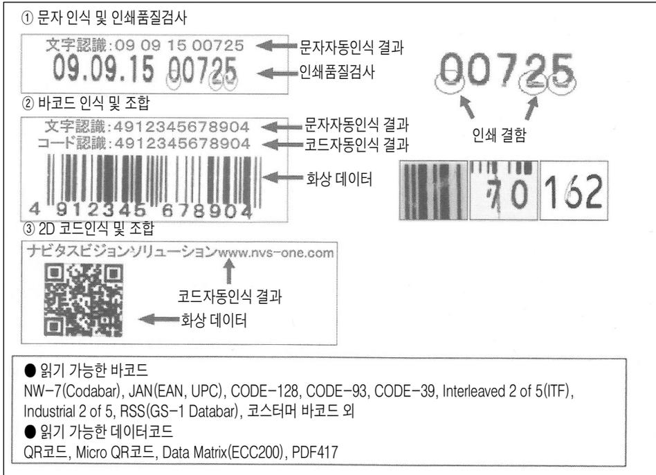
하는 가늠 어긋남 양(예 : 0.5mm 가늠 어긋남)을 허용해 OK로 하고, 그 어긋남 양 이하의 결함(예 : 0.2mm 문자 결함 등)을 NG로 처리하는 기술이다([그림 3]).
