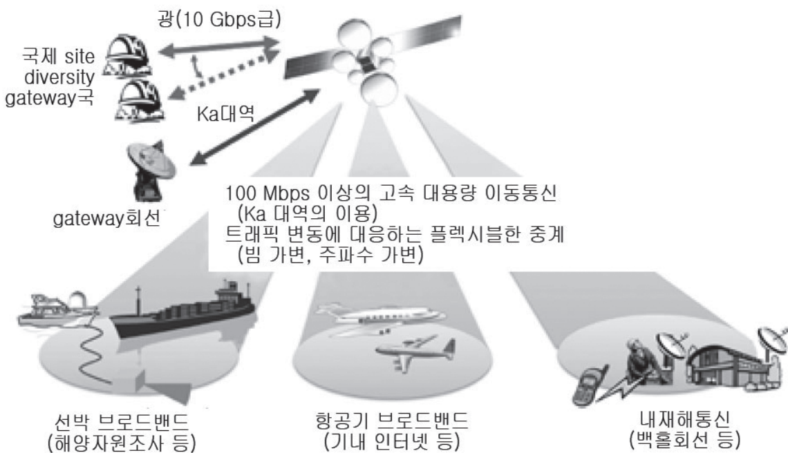
그림1: ETS-IX에 의한 전파·광 하이브리드 위성통신
