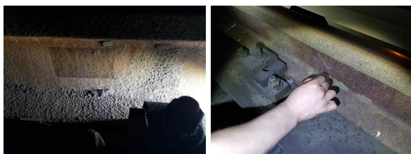
그림 3. 셀로판테이프법을 이용한 부식상태 조사 전경 Figure 3. Inspection of corrosion state by cellophane tape method
