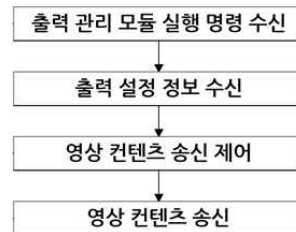
<그림 6> 다중 실시간 방송 채널 자동 전송 방법에서 출력 관리 모듈의 실행이 포함된 순서도
