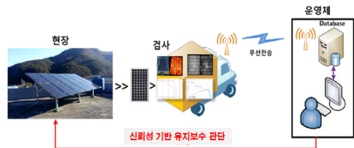
그림 9. 현장 모듈의 출력값/EL/열화상/ 다이오드특성 기반의 고신뢰성 유지보수 운영
