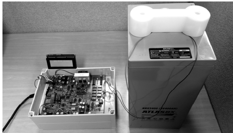
그림 7. 위상응답측정장치에 의한 배터리 진단 Fig. 7. Battery diagnosis by phase response measurement device
