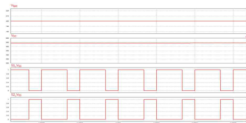
그림 13. 양방향 벡-부스트 컨버터 시뮬레이션 파형(VBATT 200V, VDC 540V) Fig. 13. Simulation Waveform of Bidirectional Buck-Boost Converter(VBATT 200V, VDC 540V)
