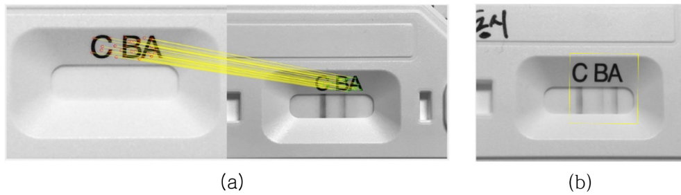
그림 4. 특징점 기반의 영상 변환 기법 : (a) 영상 정합, (b) 영상 정합을 이용한 키트 정합결과. Fig. 4. Image transform with feature point : (a) Image matching, (b) Image transform.
