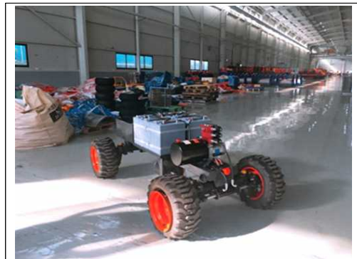
그림 2. 구동력 및 운동저항예측을 통한 시뮬레이션용 모델 Fig. 2. Model for simulation through prediction of driving force and kinetic resistance
