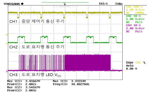
그림 14. 터널 내부 스마트 도로 표지병 시스템 통신 주기
