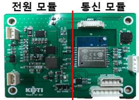
그림 7. IoT 센서 모듈의 시제품 Fig. 7. Prototype of IoT Sensor Module
