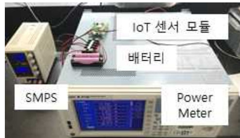
그림 8. 전원 모듈의 실험 환경 Fig. 8. Experimental Environment of Power Module
