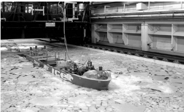
그림 3 Stena DrillMAX ICE의 모델 테스트 (HSVA)
