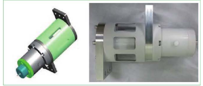
그림 9 고속 바이패스 스위치(3.6kV, 1500A)
