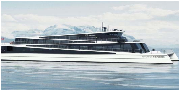
그림 1(b) 노르웨이 Future of the Fjords (2018년 운항, All Electric, 2.4MWh ESS)
