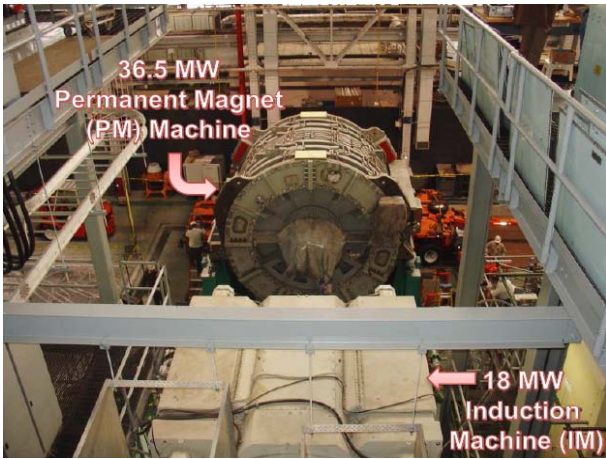
그림 5 미국 DRS사의 36.5MW급 영구자석형 전동기와 18MW급 유도전동기
