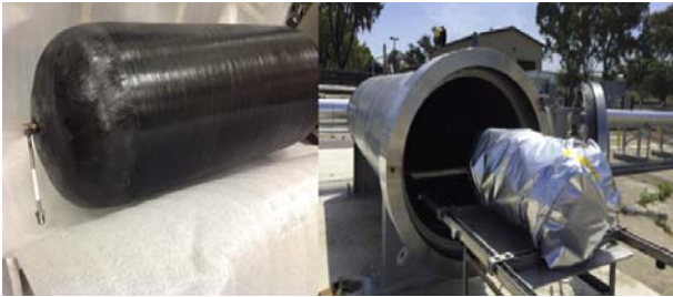
그림 2 MLI (multi-layer insulation)가 장착된 극저온 액화가스 저장탱크
