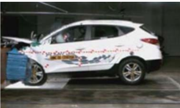
그림 13 수소 연료전지 자동차 충돌시험 - 70% 부분 후방추돌 시험(위) 및 40% 부분 정면충돌 시험(아래)
