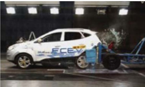
그림 12 연료공급시스템 고정성 시험
