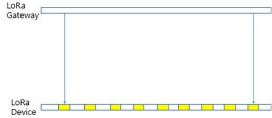
그림 3. LoRa Class B의 동작 방식
