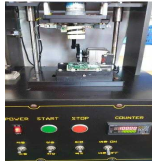
그림 22. 내구성 검사 장비 Fig. 22. Durability inspection equipment
