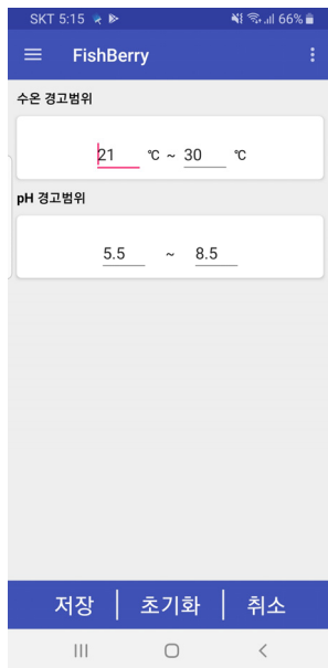
그림 5. FishBerry앱의 온도 및 pH 범위 설정 액티비티 Fig. 5. Temperature and pH range settings activity of Fishberry App
