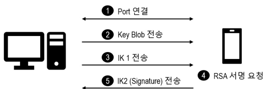
(그림 3) Client-Server형 애플리케이션을 이용한 RSA Sign 동작 과정
