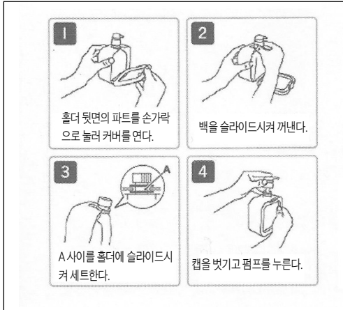
[그림 3] 간단 리필 스파우트 부착 거식 파우치의 장착방법교
