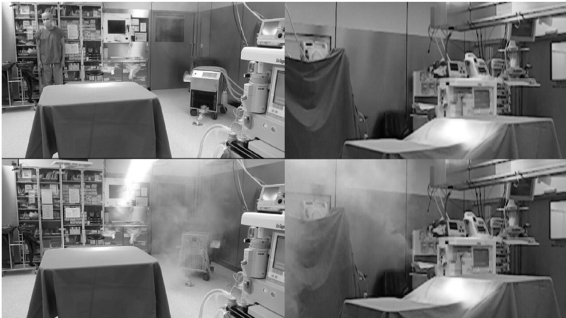
그림 3. HCU에서 분출된 균이 HCU의 수평방향 공기 흐름과 수술장의 천장에서 바닥으로 내려오는 laminar flow 합쳐지면서 수술 침대로 균이 전파되는 시뮬레이션 실험(reference 10 논문에서 그림 인용)
