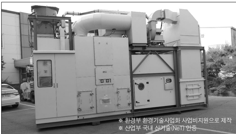
[사진 2] 가변 농축 저온 촉매연소기술이 적용된 시제품
