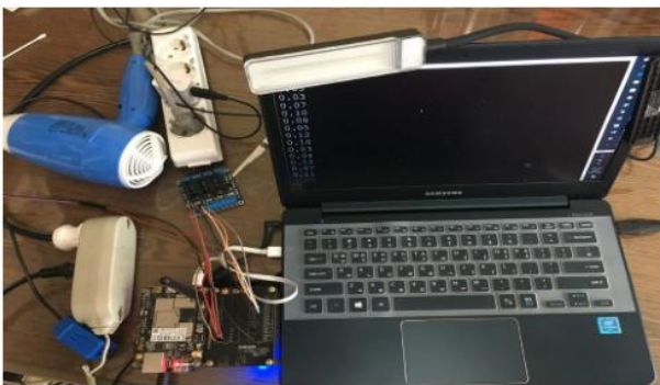
Fig. 5. Smart metering system with LED light off due to control signal. 그림. 5. 제어 신호로 인해 LED 등이 꺼진 상태의 스마트미터기
