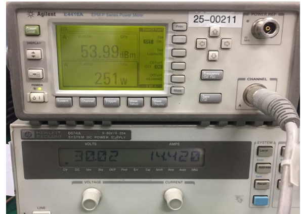
그림 6. 종단 전력증폭기의 출력과 소모 전류 Fig. 6. Output power and current consumption of final amplifier.
