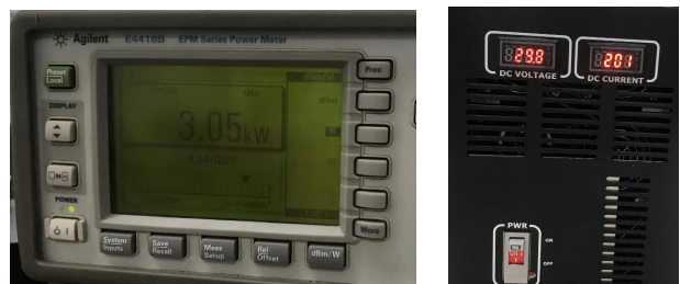
그림 11. 고출력 신호 발생 장치의 최종 출력과 소모전류 Fig. 11. Measurement output power and current consumption of high power generator.
