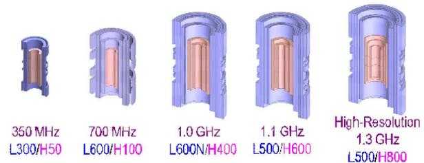
그림 2. MIT/FBML 3단계 NMR 자석 모형도
