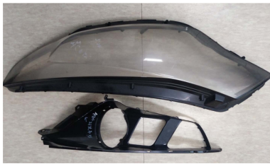
그림 3. 부적정한 캐비티 온도에 의한 사출 성형품 Fig. 3. Molded parts by improper cavity temperature.
