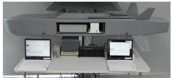
그림 5. 항공기-무장 연동 모의용 테스트 벤치
