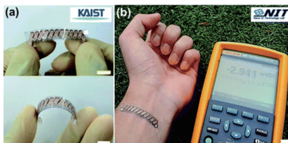
그림 5. 피부 부착형 열에너지 수확소자 (출처: 참고문헌 [9])
