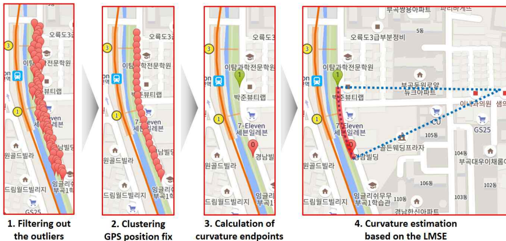
Fig. 6. Road curvature estimation scheme 그림 6. 도로 곡률 추정 기법
