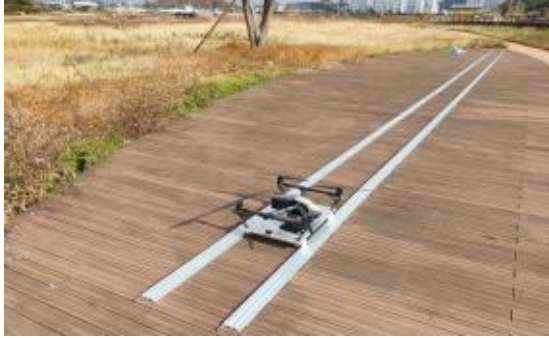
그림 3. 트랙이동시험 수행 사진 Fig. 3. Track moving test.
