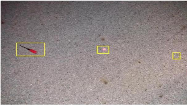
그림 10. EO/IR 카메라 대상 FOD 물질 활주로 배치
