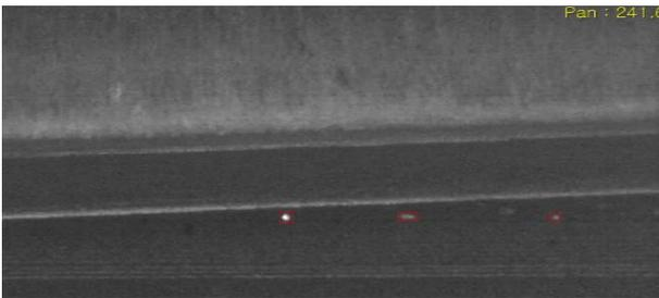
그림 11. EO/IR 카메라 FOD 탐지
