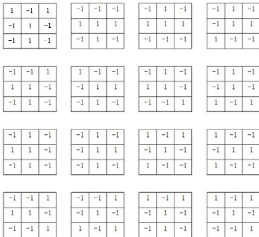
그림 6. 3교차점의 16가지 분류 Fig. 6. 16 Probes for Recognition of Three-crossing Point Structure
