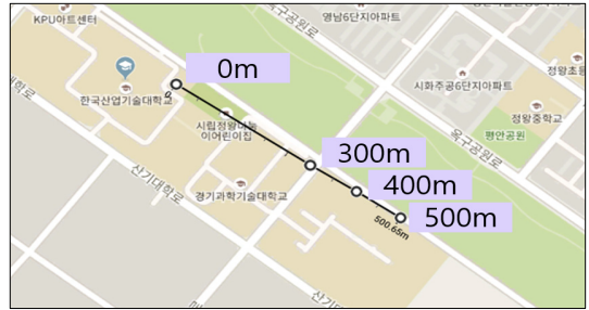
그림 10. 비 가시거리에서의 LoRa 측정 위치 Fig. 10. LoRa measurement positions at non-visible range
