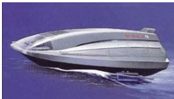
그림 3 초전도전자추진선 YAMATO-1 (출처: NAVER지식백과)
