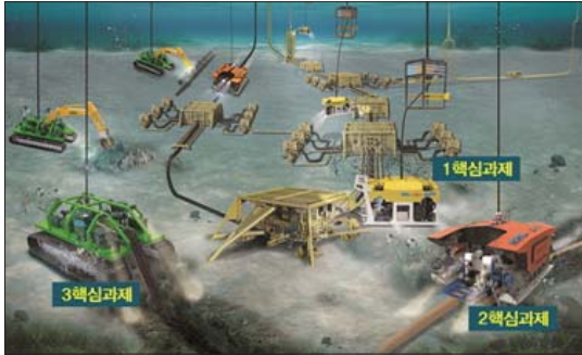
그림 14. 수중건설로봇사업단 3개 로봇의 적용(예)
