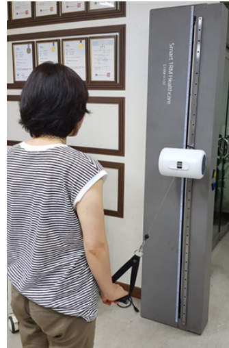
그림 1. 디지털 폴리 기반 휴대용 1RM 측정시스템 Fig. 1. The smart 1RM healthcare system for measuring maximal muscle strength(Smart 1RM healthcare system, Cybermedic, Co., Ltd., Korea)
