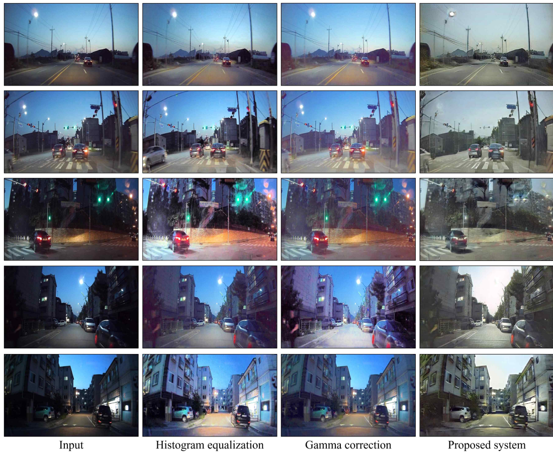
그림 4. 이미지 변환 알고리즘 별 정성적 결과 비교. 각 행은 입력 영상에 따른 알고리즘 별 출력 영상을 나타낸다. 왼쪽부터 순서대로 입력, 히스토그램 평활화, 감마 보정, 제안하는 시스템.
