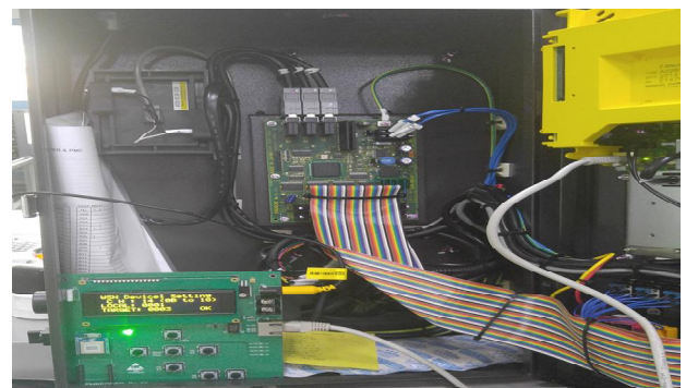
Fig. 2. Management board connected to machine tool PMC. 그림 2. 공작기계 PMC와 연결된 매니지먼트 보드
