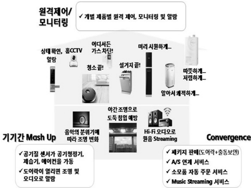
그림 7. SKT '스마트홈' 시스템 구성
