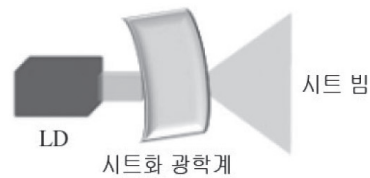
그림8 DPSS 시트 빔과 우시오전기제(반도체 레이저) 시트 빔의 비교
