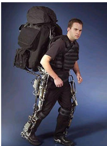
(그림 1) 외골격형 근력증강 시스템
