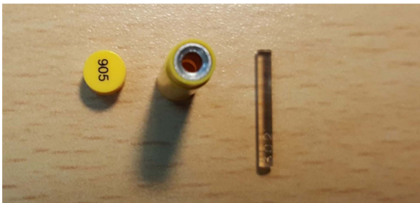
그림 4. 형광유리선량계의 플라스틱 캡슐과 주석 필터. Fig. 4. RPL dosimeters made of phosphate glass with a plastic capsule and tin filter.
