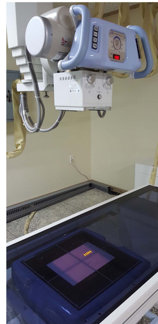
그림 2. 형광유리선량계를 이용한 엑스선 선량 측정. Fig. 2. X-ray dose measurement of radiophotoluminescent glass dosimeters.
