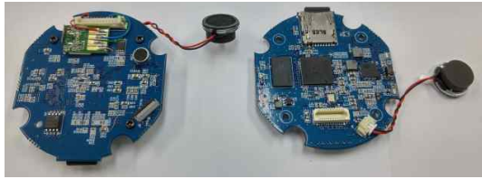
Fig. 8. Dash Camera board with 360 ° omnidirectional angle of view 그림 8. 360° 전방위 화각을 가진 Dash Camera 보드
