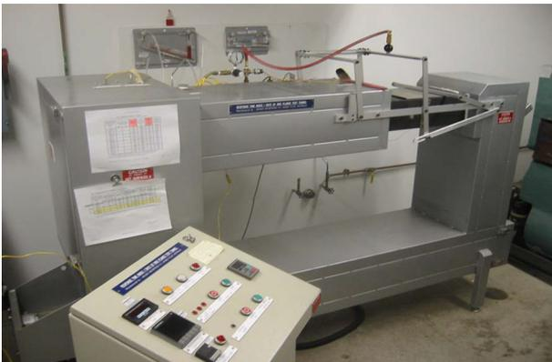
Fig. 1. Plunge tunnel(FM Global).
