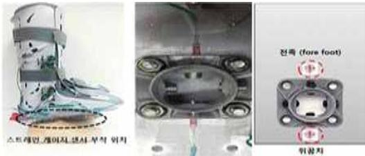
그림 7. 지면반발력 측정을 위한 기구 제작
