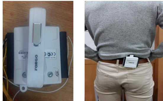
그림 1. 클립이 부착된 DAQ 보드와 허리에 장착된 모습
