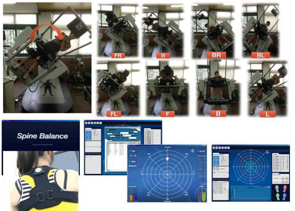
그림 8. 피험자의 Spine Balance 3D 동적자세균형 평가 장치를 이용한 균형능력 평가 Fig. 8. Evaluation of balance ability using spine balance 3D dynamic postural balance evaluation device
